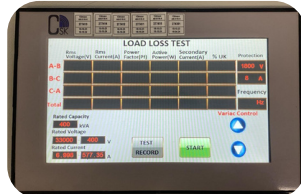
YÜKTE KAYIP TEST / LOAD LOSS TEST
